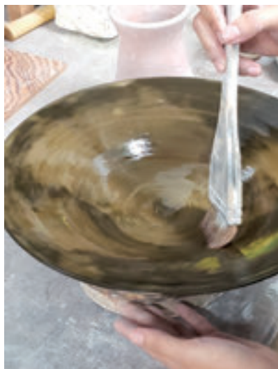
ラスタースター液を塗る工程では、厚すぎず薄すぎず液を塗る繊細な力加減が必要。
